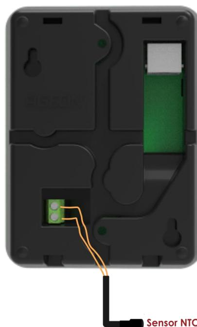
Nunca submeta o seu sensor a uma temperatura fora da faixa de medição  $-50$  a  $+100$  °C, pois isto pode causar danos irreversíveis.
