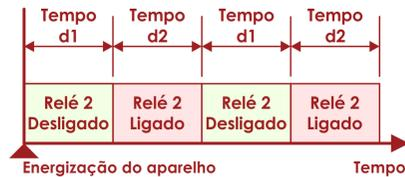
**d1 Tempo do relé 2 desligado:** determina o tempo que o relé 2 permanece desligado, conforme a sequência cíclica mostrada na figura acima.
