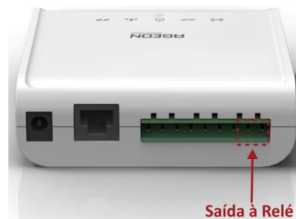
Figura 30 - Localização do borne Saída à Relé
