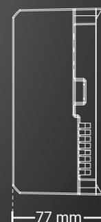
Os inversores de frequência IEX70 foram desenvolvidos especialmente para controlar a velocidade de esteiras ergométricas. Possuem design exclusivo, formato compacto e um gabinete de proteção que facilitam a instalação e impedem a entrada de resíduos. Os inversores IEX70 podem ser utilizados em 110 V ou 220 V, pois possuem
