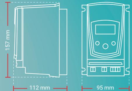
O equipamento FanSpeed controla a velocidade do ventilador de acordo com a pressão definida no setpoint, evitando o congelamento do evaporador. A medição da pressão do sistema é feita por meio de um transdutor de pressão, que pode ser adquirido junto com o equipamento ou obtido a parte.
